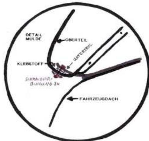
Verbindung per Schrauben und Kleben
