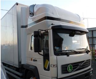
**AERO-SPACE Seitenflügel für Volvo FL, Mittleres Fahrerhaus L2H1 B ca.2400, Ü 40mm**
