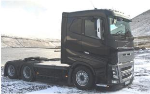
**AERO-OVER Rahmenverkleidung für Volvo FH V4 Euro 6, Sattelzugmaschine Radstand 3800 mm, mit freitragenden Stufen für kleinen Kraftstofftank auf Fahrerseite**
