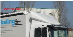
**VARIO-FIX 3D-Dachspoiler 2-teilig für Volvo FL / FE, Bj.07, Kurzes Fahrerhaus L1H1, B 2400 x H 450-800 mm**
