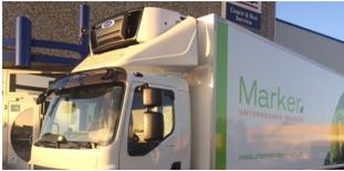
**VARIO-FIX 3D-Dachspoiler 2-teilig für Volvo FL / FE, Bj.07, Kurzes Fahrerhaus L1H1, B 2400 x H 800-1150 mm**
