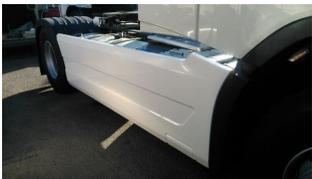
**AERO-OVER Rahmenverkleidung für Volvo FH V4 Euro 6, Sattelzugmaschine Radstand 3800 mm, mit Stufen im großen Kraftstofftank auf Fahrerseite**
