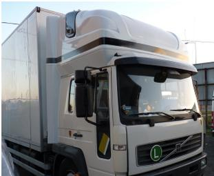
**AERO-SPACE Dachschlafkabine für Volvo FL / FE, kurzes Fahrerhaus L1H1 B 2060 x H 900, Ü 40mm**
