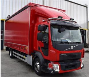
**VARIO-FIX 3D-Dachspoiler 2-teilig für Volvo FL, Bj. 07, Mittleres Fahrerhaus L2H1 B 2155 x H 600-940 mm**
