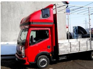
**AERO-SPACE Dachschlafkabine für Renault Maxity / Nissan NT 400, Normalfahrerhaus B 2200 x H 900, Ü 40mm**
