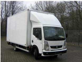
**CLASSIC 3D-Dachspoiler für Renault Maxity, Nissan NT 400, Normalfahrerhaus B 2000 x H 600 mm**
