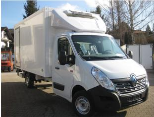
**VARIO-FIX 3D-Dachspoiler 2-teilig für Renault Master NEU / Nissan NV400, Normalfahrerhaus B 2000 x H 730-900mm**
