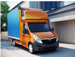
**AERO-SPACE Dachschlafkabine für Renault Master / Nissan NV400, Normalfahrerhaus B 2060 x H 900, Ü 40mm**
