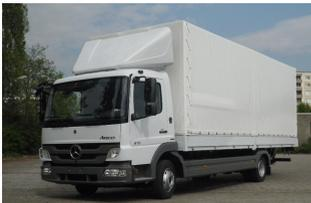
**VARIO-FIX 3D-Dachspoiler 2-teilig für Mercedes Atego/Axor, S-Fahrerhaus F07/F20 B 2400 x H 800-1000 mm**
