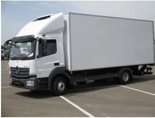
**CLASSIC 3D-Dachspoiler für Mercedes Atego/Axor, S-Fahrerhaus F07/F20 B 2275 x H 850 mm, Original Sonnenblenden Halter und Lufthörner müssen am Spoiler ausgeklinkt werden.**
