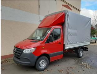
**CLASSIC 3D-Dachspoiler für Mercedes Sprinter NCV3 / 2018 VS30 / BM 906/907/910, Normalfahrerhaus B 2000 x H 750 mm**
