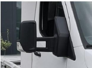
**Spiegelverbreiterung für MB Sprinter 2018 Tiefe 120mm 1 Satz links und rechts, inkl. 6 Schrauben M6 x 140mm und 20cm, Klebstoff schwarz zur Montagehilfe**
