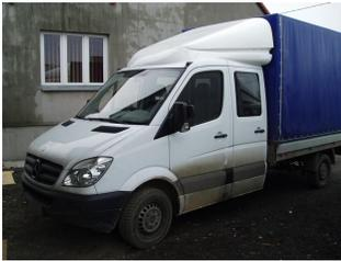
**VARIO-FIX 3D-Dachspoiler 2-teilig für Mercedes Sprinter NCV3 / 2018 VS30 / BM 906/907/910, Doppelkabine B 2000 x H 550-750 mm**
