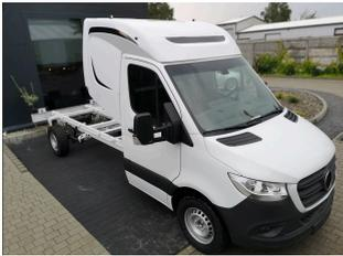
**DEEPSLEEPER Fernfahrerhaus für Autotransporter für Mercedes Sprinter 2018 VS30 BM 907-910, Normalfahrerhaus B 2090 x H 412 / 2040mm ab Fahrgestell**
