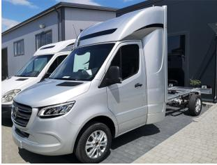
**DEEPSLEEPER Fernfahrerhaus für Mercedes Sprinter 2018 VS30 BM 907-910, Normalfahrerhaus B 2290 x H 680 / 2310mm ab Fahrgestell, mit Ablagetisch, Stauraum und 600mm Bett**
