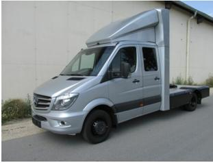
**VARIO-FIX Seitenflügel für Mercedes Sprinter NCV3 / 2018 VS30 / BM 906/907/910, Doppelkabine B 2150 x H 900/Ü200 mm**
