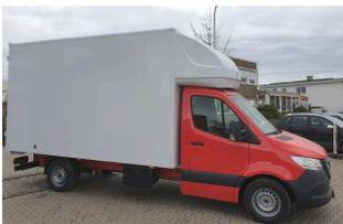
**SPACE-LINE Dachüberbau freihängend für Mercedes Sprinter NCV3 BM906 / 2018 VS30 BM 907-910, Normalfahrerhaus, B 2090 x H 600mm**
