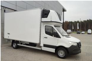
**PROLINE Dachschlafkabine neues Design für Mercedes Sprinter 2018 VS30 / BM 907/910, Normalfahrerhaus B 2150 x H 1000, Ü 40mm**
