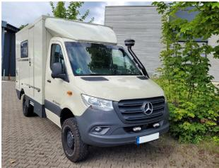
**CLASSIC 3D-Dachspoiler für Mercedes Sprinter NCV3 / 2018 VS30 / BM 906/907/910, Normalfahrerhaus B 2000 x H 450 mm**
