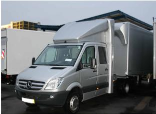
**VARIO-FIX Seitenflügel für Mercedes Sprinter NCV3 / 2018 VS30 / BM 906/907/910, Doppelkabine B 2150 x H 600/Ü200 mm**
