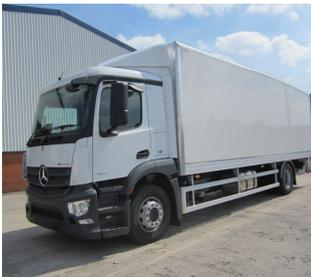
**VARIO-PLUS Aeropaket für Mercedes Actros / Antos, M-Fahrerhaus mit Luftansaugung oben, Classic Space 170mm Motortunnel B 2495 x H 525-800/Ü285 mm**
