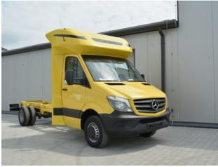
**SPACE-LINE Dachüberbau fest mit Seitenflügel für Mercedes Sprinter VS30 / BM 907/910, kurz ohne Rückwand für Verkaufsfahrzeuge / Wohnmobile, B 2305 x H 502mm/Ü470mm**
