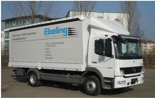
**VARIO-FIX 3D-Dachspoiler 2-teilig für Mercedes Atego/Axor, S-Fahrerhaus F07/F20 B 2400 x H 450-700 mm**
