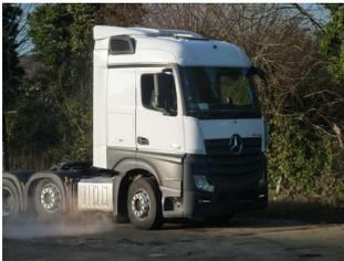
**VARIO-PLUS Aeropaket für Mercedes Actros NEU, StreamSpace Fahrerhaus mit Luftansaugung M8B rechts oben, 2500mm breit B 2545 x H 270-420/Ü325 mm**
