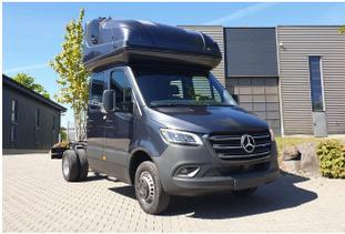
**AERO-SPACE Dachschlafkabine für Mercedes Sprinter 2018 VS30, Doppelkabine B 2060 x H 900, Ü 40mm**
