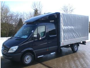
**VARIO-FIX Seitenflügel für Mercedes Sprinter NCV3 / 2018 VS30 / BM 906/907/910, Doppelkabine B 2150 x H 600**
