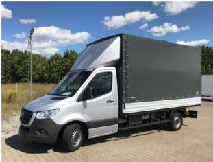
**CLASSIC 3D-Dachspoiler für Mercedes Sprinter NCV3 / 2018 VS30 / BM 906/907/910, Normalfahrerhaus B 2000 x H 900 mm**
