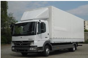
**VARIO-FIX 3D-Dachspoiler 2-teilig für Mercedes Atego/Axor, S-Fahrerhaus F07/F20 B 2400 x H 800-1000 mm**
