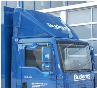
**VARIO-PLUS 3D-Dachspoiler für MAN TGL/TGM 3 Neu, C-Fahrerhaus B 2200 x H 570-800 mm**
