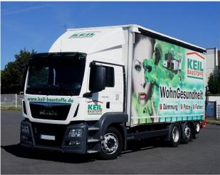
**VARIO-PLUS 3D-Dachspoiler für MAN TGS, L-Fahrerhaus B2200xH 550-900 mm**
