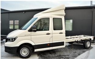
**VARIO-FIX 3D-Dachspoiler 2-teilig für VW Crafter NEU / MAN TGE, Doppelkabine B 2000 x H 580 - 750 mm**
