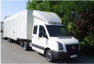
**VARIO-FIX 3D-Dachspoiler 2-teilig für VW Crafter NEU / MAN TGE, Doppelkabine B 2000 x H 530(470)-920 mm**
