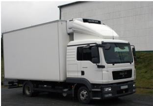
**VARIO-FIX 3D-Dachspoiler 2-teilig für MAN TGL/TGM/TGS, L-Fahrerhaus B 2250 x H 600-950 mm**
