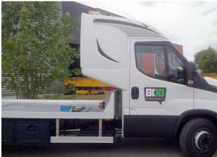
**DEEPSLEEPER Fernfahrerhaus für VW Crafter Autotransporter, Normalfahrerhaus B 2080 x H 290mm/T540 mm**
