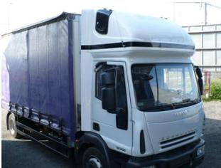
**AERO-SPACE Dachschlafkabine für Iveco Eurocargo, Normalfahrerhaus B
