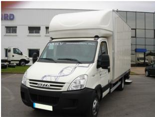
**SPACE-LINE Dachüberbau freihängend für Iveco Daily, Normalfahrerhaus B 2090 x H 660 mm**
