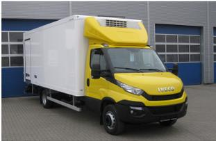
**VARIO-FIX 3D-Dachspoiler 2-teilig für Iveco Daily, Normalfahrerhaus B 2000 x H 730-900mm**
