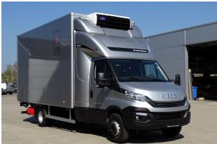
**DEEPSLEEPER Fernfahrerhaus für Iveco Daily 2014, Normalfahrerhaus B 2290 x H 670mm/T540 mm, mit Ablagetisch, Stauraum und 600mm Bett, Fahrgestell ab Werk, ohne Rückwand bestellen!**
