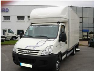
**SPACE-LINE Dachüberbau freihängend für Iveco Daily, Normalfahrerhaus B 2090 x H 760 mm**
