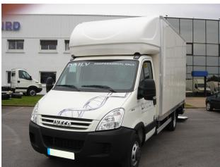
**SPACE-LINE Dachüberbau freihängend für Iveco Daily, Normalfahrerhaus B 2090 x H 860 mm**
