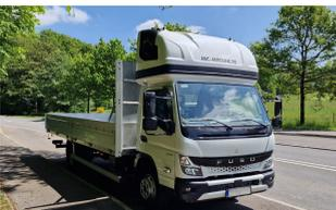
**AERO-SPACE Dachschlafkabine für Fuso Canter, C-Fahrerhaus B 2060 x H 900, Ü 40mm**
