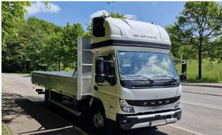
**AERO-SPACE** Dachschlafkabine für Fuso Canter, C-Fahrerhaus B 2060 x H 1000, Ü 40mm
