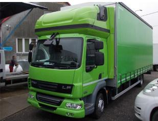
**AERO-SPACE Seitenflügel für DAF LF, kurzes Fahrerhaus B ca.2400, Ü 40mm**
