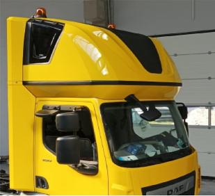
**PROLINE Dachschräfkabine neues Design für DAF LF, kurzes Fahrerhaus, B2150 x H1000, Ü40mm**
