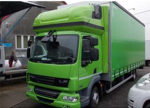
**AERO-SPACE Dachschräfkabine für DAF LF, kurzes Fahrerhaus B 2200 x H 920, Ü 40mm**
