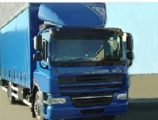
**LOOK-ALIKE 3D-Dachspoiler für DAF CF 65/75/85, kurzes Fahrerhaus B 2100 x H 650-850 mm**
