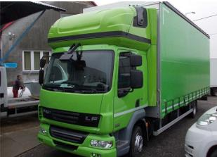
**AERO-SPACE Dachschlafkabine für DAF LF, kurzes Fahrerhaus B 2200 x H 920, Ü 40mm**
