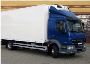
**VARIO-FIX 3D-Dachspoiler 2-teilig für DAF LF, Fernfahrerhaus B 2155 x H 600-940 mm**
